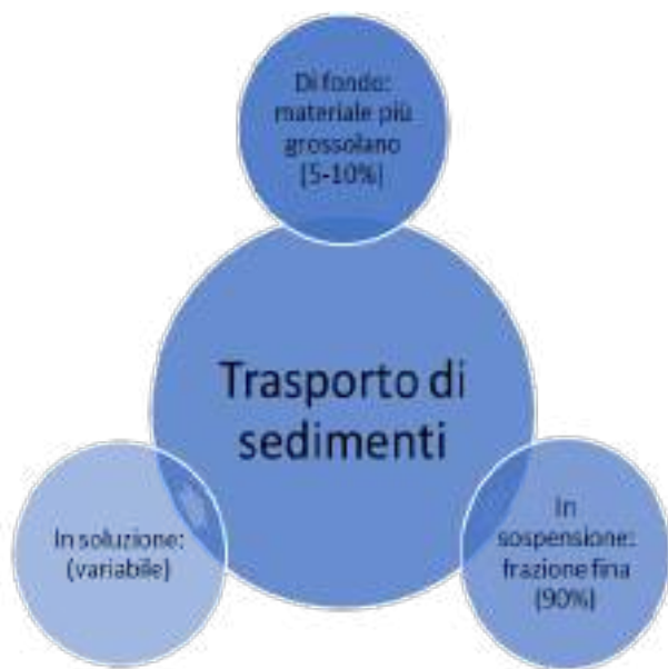
Fig. 1.4. Schematizzazione del trasporto dei sedimenti Fonte: elaborazione propria
